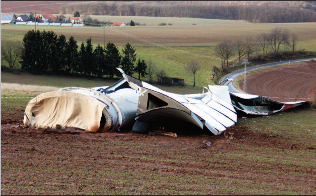
Diese Aufnahme entstand wenige Tage nach dem Abbruch des ca. 60 m langen und etwa 60 Tonnen schweren Rotorblattes der E 126 von Juwi bei Gerbach (Donnersberg). Die Unfallstelle war, nicht weitläufig abgesperrt. Der Unfall ereignete sich am 30.12.2013.
